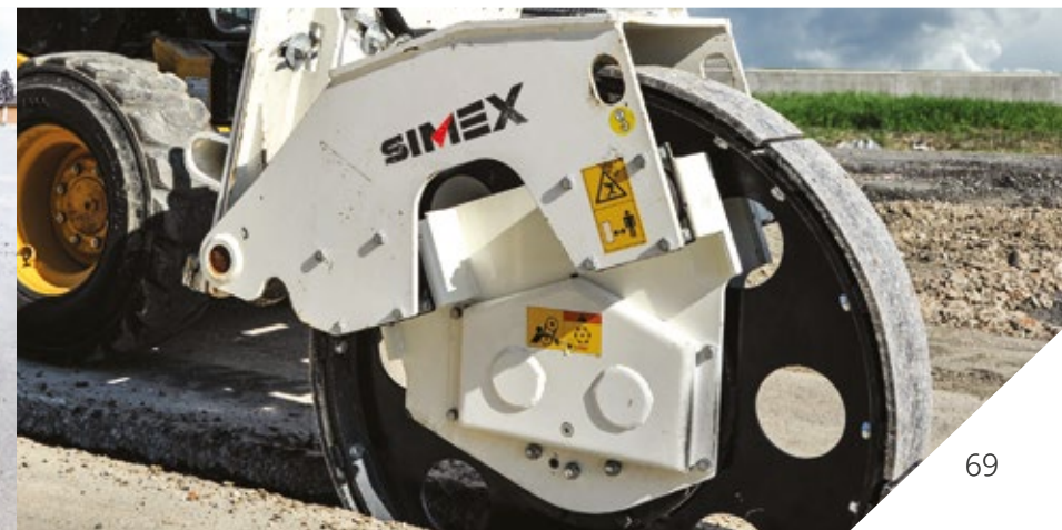
CT 2.8 F.O. Compactación fuera de perfil de una excavación de sección predefinida después de la colocación de los canales subterráneos.
