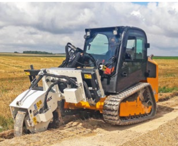
CT 2.8 F.O. Compactación fuera de perfil de una excavación de sección predefinida después de la colocación de los canales subterráneos.
