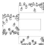
TAMBOURS DOUBLE LARGEUR Tambours à demi-coquilles amovibles (PL 1000 uniquement).
